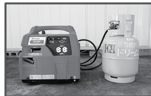
発電機 プロパンガスを利用して発電します。
