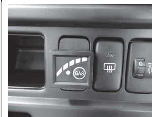
LPGタンク残量計は 独立設置です
